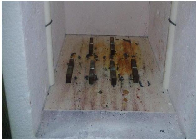
**Gambar 2.** Spesiment Uji *Impact*
